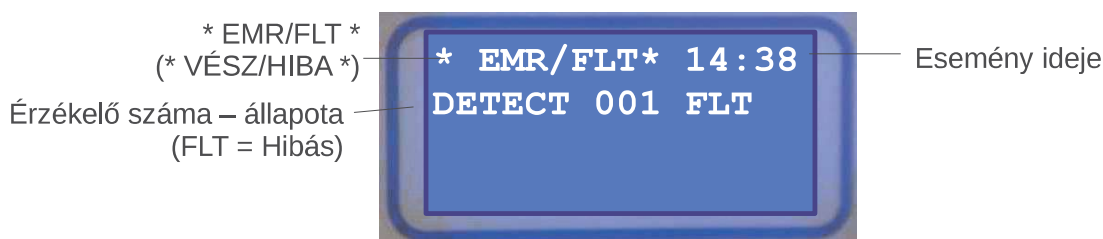
19. ábra: A FAULT (Hiba) állapot kijelzése
